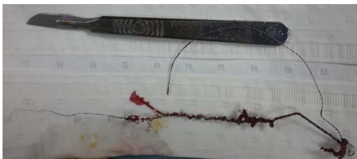
Фиг. 6. Фрагмент от 8-годишен деснокамерен електрод, екстрахиран през феморален достъп. Показано е тежкото деструктуриране на екстрахирания електрод / Fig. 6. Fragment of 8-year-old RV lead extracted through femoral access. It reviews the heavy destruction of the extracted lead
